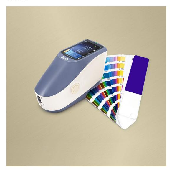
YS4510 通用型分光测色仪采用符合 CIE No.15 的 45/0 (45 度环形照明, 0 度接收) 几何光学结构,采用凹面光栅分光方式,可精确测量样品反射率及各种色度数据。用户可根 据样品需求定制单一Φ8、Φ4、或Φ2mm 测量口径,用于交通路标、塑胶电子、油漆油墨、 纺织服装印染、印刷、陶瓷等行业精确颜色测量和品质控制。
